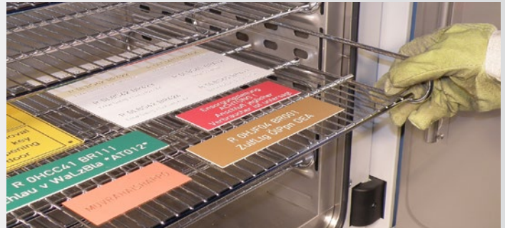
Hitzebeständig: Hitze-Test von Thermograv® -Schildern bei 135°C
